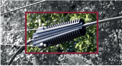
**KONISCHE KLEMMUNG.** Das Prinzip dieser Technologie ist einfach: Je mehr wir das Kabel anziehen, desto mehr zieht sich das Kabel in die Klemme hinein. Bietet eine schnelle, werkzeuglose Installation und eine einfache Justierung bei Kabelabsackung. Ermöglicht das Abfangen von Vibrationen und schafft Vorteile durch die Stütze. Kompatibilität: runde Kabel mit GFK Stäbe oder Tragseilluftkabel (fig 8) mit Stahl- oder Tragseilen mit Dielektrikum (Spannweite bis 180 m).
