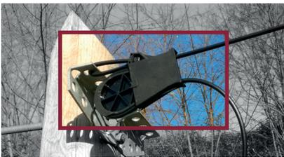
**KEILKLEMMEN.** Lösung auf Basis eines Keildesigns, das eine verbesserte Adaption des Kabels sowie einen effizienten Kabelgriff gewährleistet. Kompatibilität: Runde, Flachglasfaser- und Kupferkabel. Für runde optische Kabel mit starrer Isolierung eignet sich eine verbesserte Technologie mit Klemmen in umhüllenden Keilen. In der Tat bewahrt diese Lösung alle funktionellen Eigenschaften des Kabels bei Überlastung.
