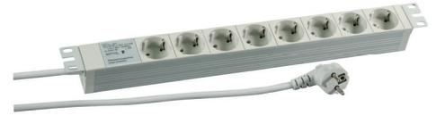
PROFIversal 8-fach, mit Geräteschutzüberspannungsfiler SAFETRONIC, optische Ausfallanzeige nach Überspannungsschaden, mit 45° gedrehten Töpfen, 44,45 mm Topfabstand, universelle Befestigungsmöglichkeit mit Metallwinkel, wiederanschließbar, Zuleitung H05VV-F3G1,5mm<sup>2</sup>, 2 m, mit Schutzkontakt-Winkelstecker, 250 VAC, 16 A, Länge 482,6 mm, CEE7/III, Aluminium
